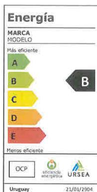
El rectángulo señalado como “OCP” en la Figura 2 se sustituirá por el sello de conformidad del OCP. Las fuentes, cotas y dimensiones de la etiqueta a color no mostradas en la Figura 2 se especifican en UNIT 1218.
